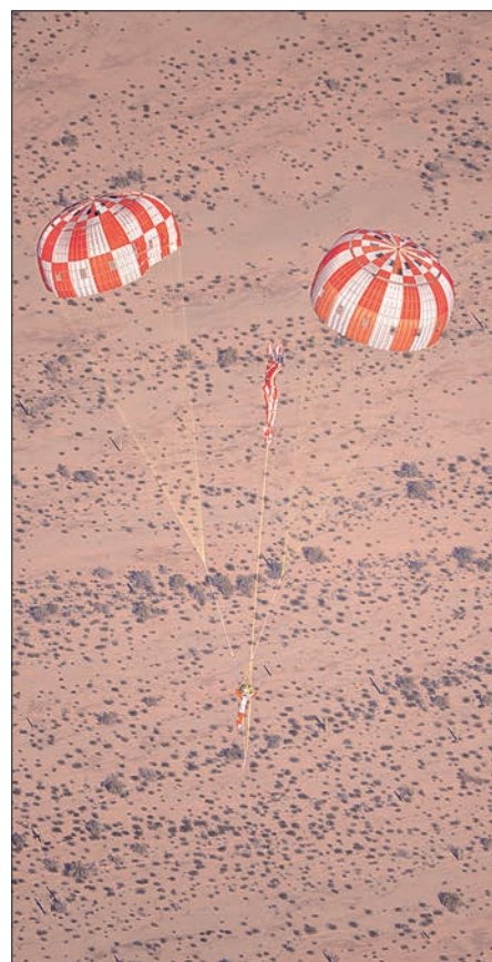
Тестовый спуск макета космического корабля Orion на двух парашютах (раскрытие третьего парашюта было намеренно заблокировано).
