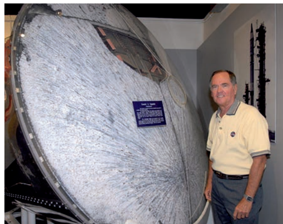
Р.Криппен рядом со спускаемым аппаратом корабля Gemini-B, который совершил полет в 1966 г. Видна крышка люка, «прорезанного» в теплозащитном экране.
